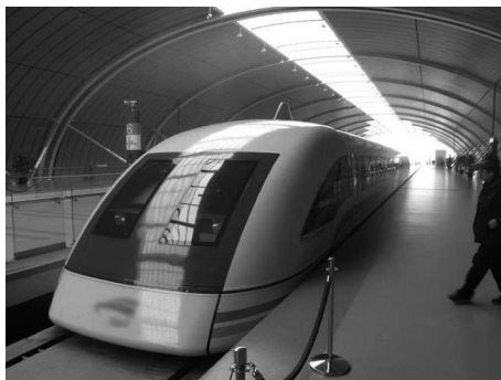
Figure 1 : Le Transrapid rejoint l'aéroport au cœur de Shanghai en moins de 8 minutes, à 250 km/h en moyenne, avec une vitesse maximale de 400 km/h.
