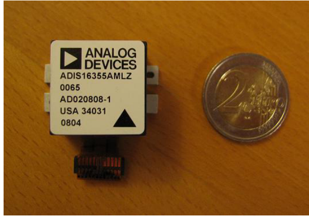
FIGURE 16 – Unité de mesure inertielle tri-axe Adis16355 d'Analog Devices
