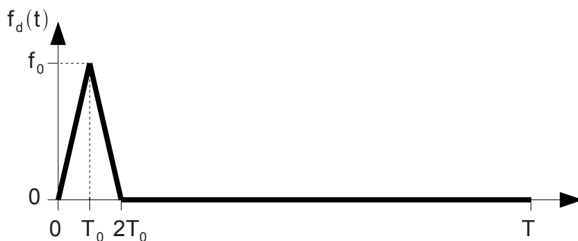
Figure 24 : modélisation adoptée pour la force créée par l'explosion du cordon pyrotechnique.
