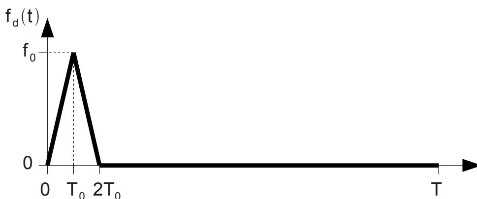
Figure 14 : modélisation adoptée pour la force créée par l'explosion du cordon pyrotechnique.
