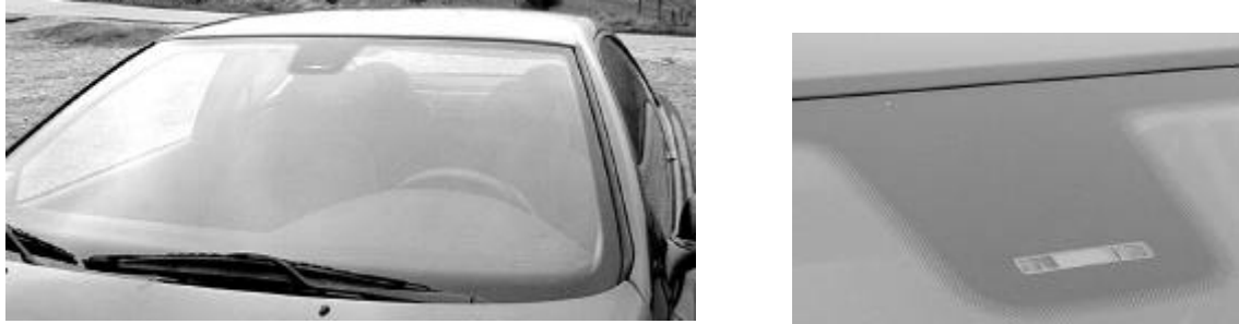
Fig. 4 : Le détecteur de pluie est placé au centre du pare-brise
