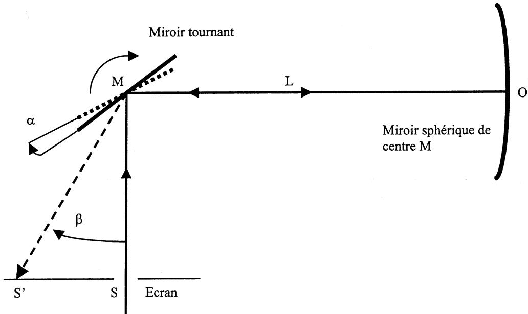
Un écran percé d'un trou en S laisse passer un faisceau lumineux qui, après des réflexions successives sur un miroir tournant plan puis sur un miroir sphérique de centre de courbure M et finalement de nouveau sur le miroir tournant, est recueilli sur l'écran à la position S'.
