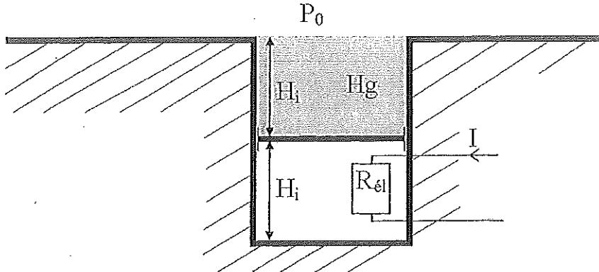
On signale que  $\mu_{Hg}gH_i = P_0/2$  où  $g = 10 \text{ m} \cdot \text{s}^{-2}$  est l'intensité du champ de pesanteur. On chauffe le gaz avec une résistance électrique  $R_{el}$  de volume et de capacité thermique négligeables parcourue par un courant d'intensité  $I$ . On arrête le chauffage lorsque le piston affleure le haut du cylindre. Déterminer la pression du gaz dans l'état initial  $P_i$  et sa température dans l'état final  $T_f$ .
