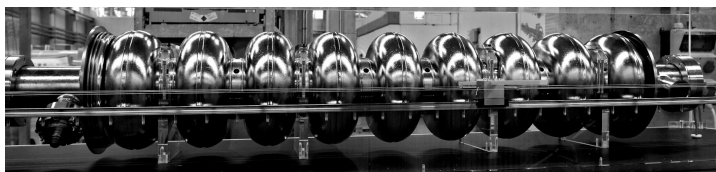
Figure 2 – Photographie montrant une cellule TESLA du XFEL européen. Source : wikipedia.
