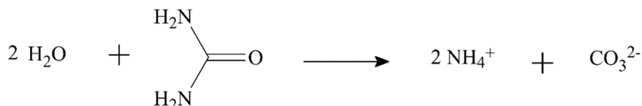
Figure 2 – Hydrolyse de l'urée en présence d'uréase.
