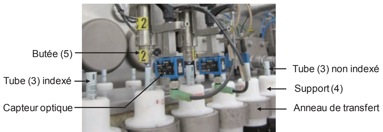
Figure 13. Poste d'indexation en rotation des tubes - début de phase de montée
