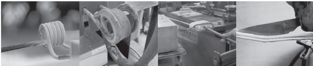
Figure 5 – Des inducteurs adaptés aux formes des pièces à forger
